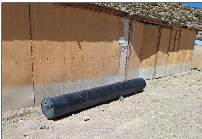
IMAGEN N° 9 ROLLO DE GEOTEXTIL NO TEJIDO COLOCADO SOBRE EL TERRENO
